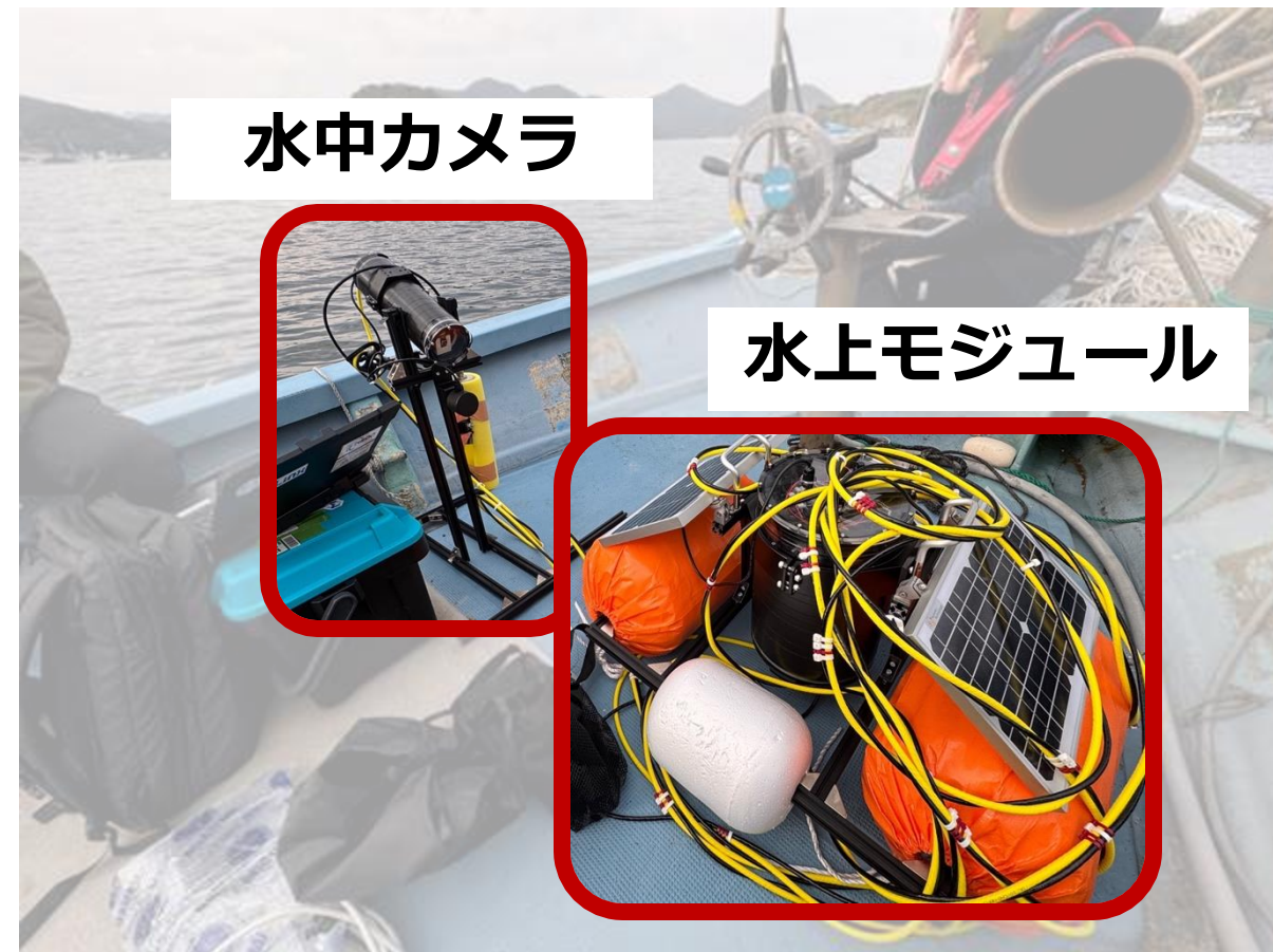
MizLink Monitorブイタイプ全体像 (水上モジュール：ソーラーパネル・バッテリー・ 通信機器・フロート)
